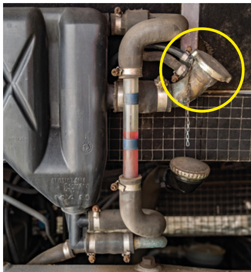
Expanzní nádobka chladicí kapaliny. V kolečku označena trubka s víčkem pro dolití.
