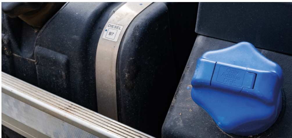
Nádrž na AdBlue je označena modře a zpravidla umístěna vedle palivové nádrže.
