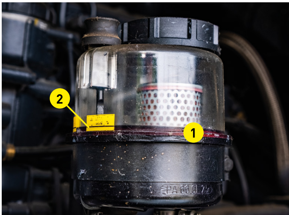
1 - nádobka hydraulického oleje, 2 - měrka pro minimální hladinu.
