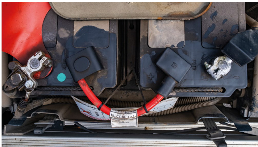
Sériové zapojení akumulátorů.
