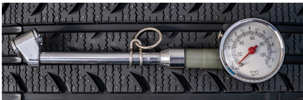
Tlak vzduchu měříme tlakoměrem na studených, jízdou nezahřátých pneumatikách.
