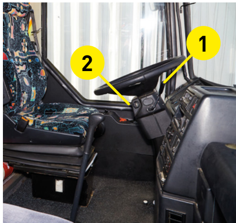
1 - ovládání elektromagnetického retardéru levou páčkou pod volantem, 2 - vlevo od volantu je vidět ovládání parkovací (nouzové) brzdy.
