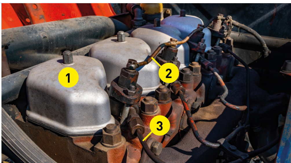
1 - hlavy válců, 2 - zpětné potrubí a 3 - vysokotlaké potrubí.
