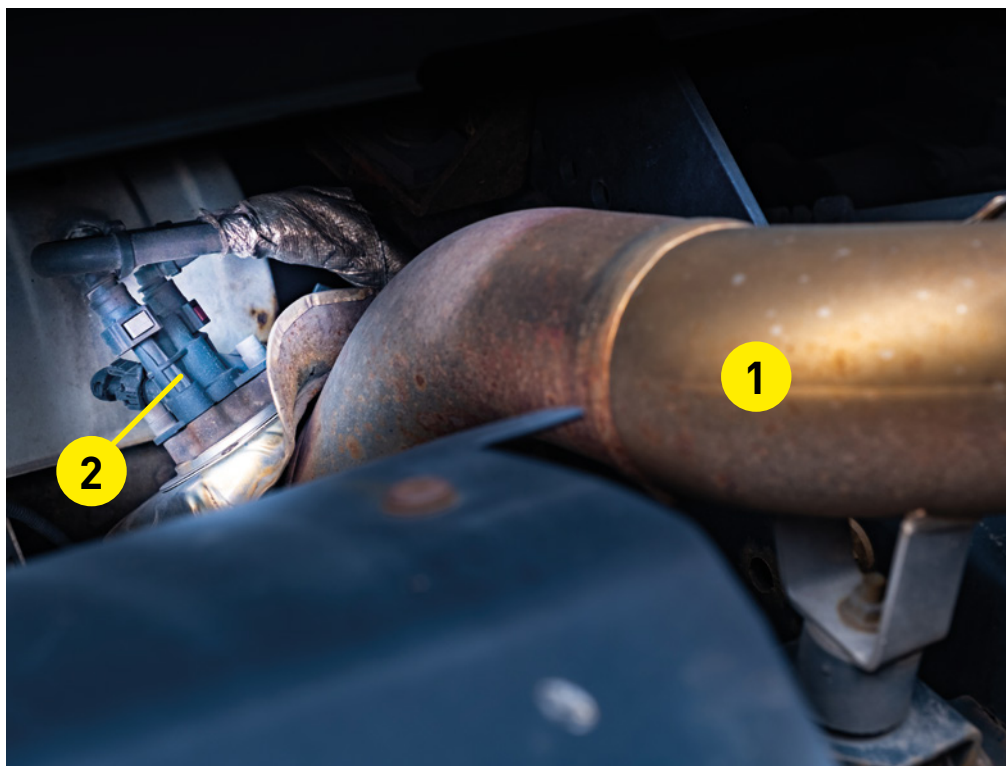
1 - výfukové potrubí, 2 - vstřikování AdBlue.
