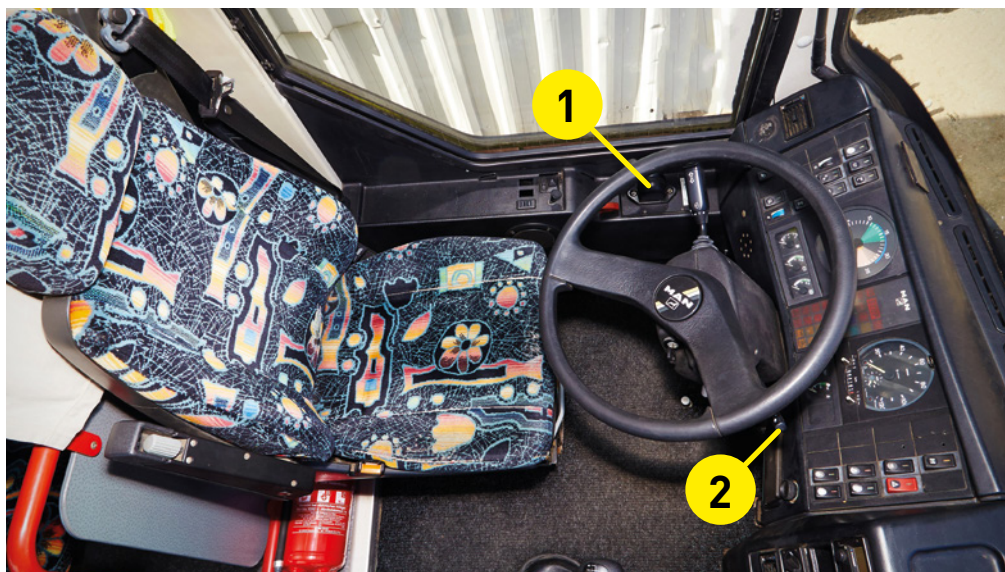
1 - ovladač parkovací (nouzové) brzdy, 2 - ovladač elektromagnetického retardéru.
