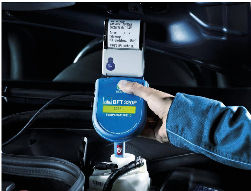
Kontrola brzdové kapaliny.
