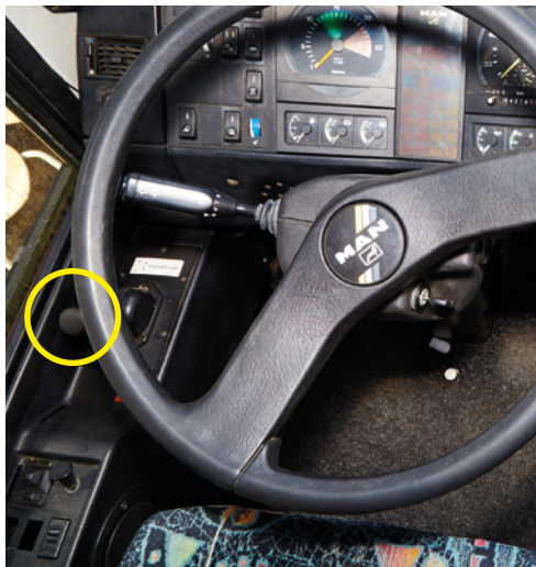
Na tomto vozidle je ovládání parkovací (nouzové) brzdy levou rukou v dosahu řidiče.
