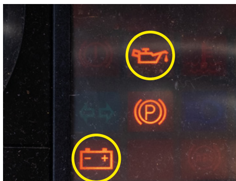
Kontrolka mazání motoru a kontrolka dobíjení akumulátoru.
