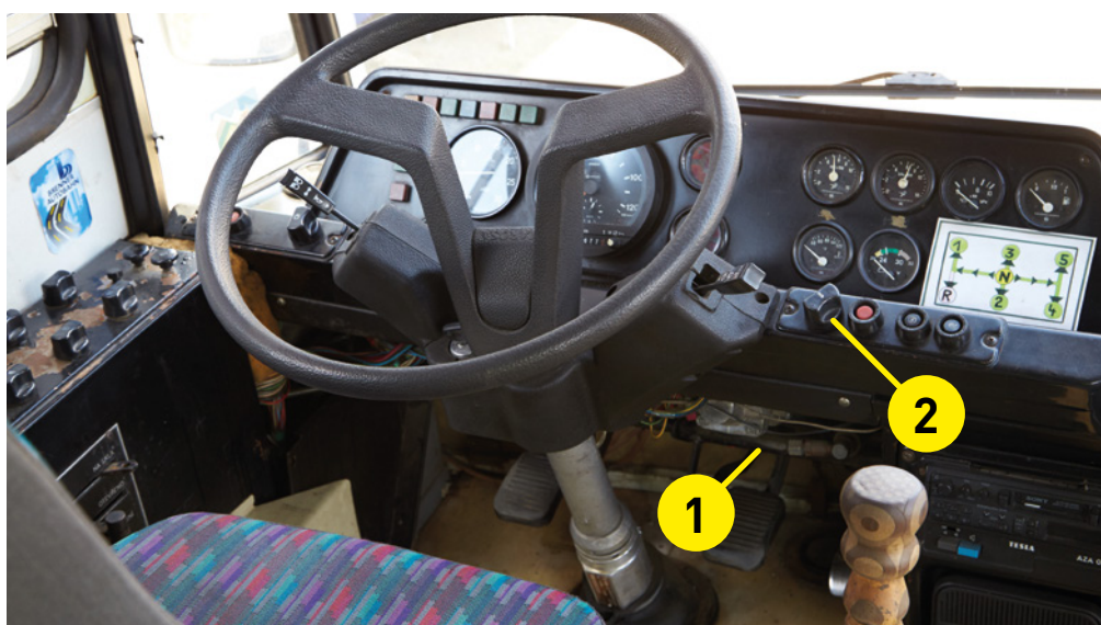
1 - sepnutí motorové výfukové brzdy je zajištěno spínačem nad brzdovým pedálem, 2 - funkci motorové výfukové brzdy lze vypnout.
