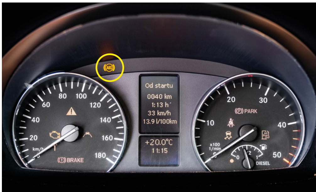
Kontrolka ABS na palubní desce je před nastartováním rozsvícena.
