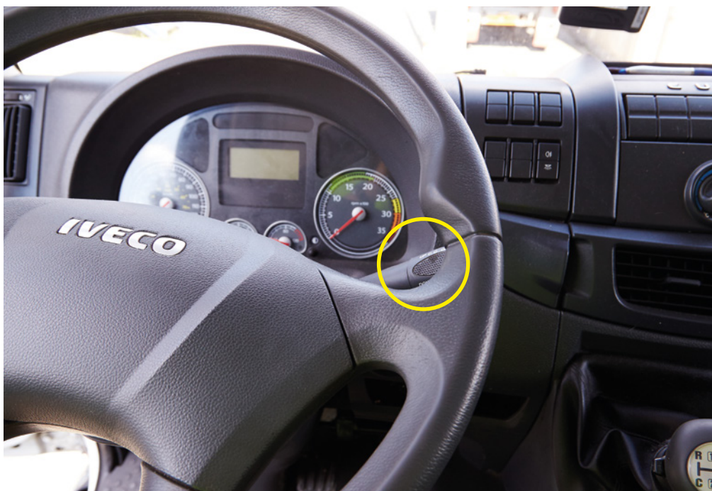
Dvoupolohový ovladač motorové výfukové brzdy. V první poloze je vypnuto, ve druhé poloze je zapnuto ovládání spínačem na pedálu brzdy, ve třetí poloze je trvale zapnuto.
