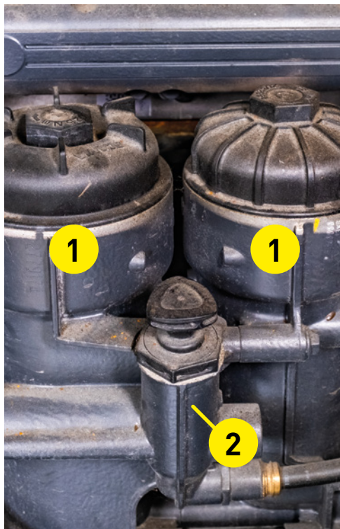
1 - dvoustupňový jemný filtr, 2 - ruční pumpička pro odvzdušnění.
