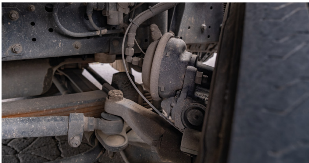
Mechanismus zavěšení kol řídicí nápravy je složitý a jeho nastavení musí být přesné. Provádíme v odborném servise.
