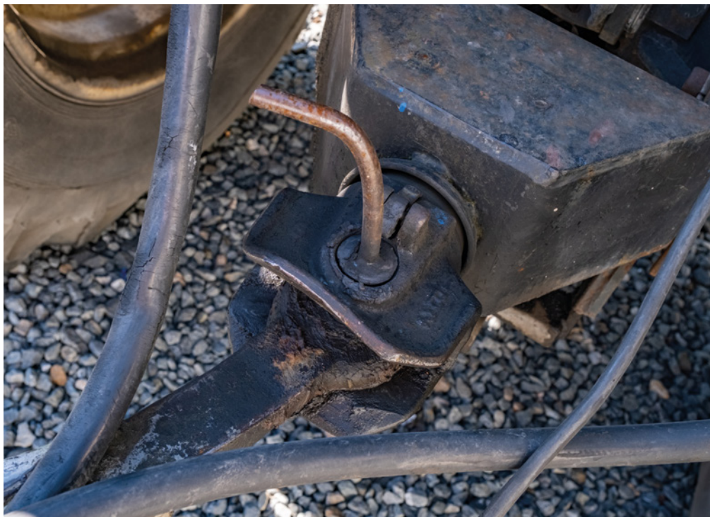
Detail nesamočinného spojovacího zařízení po připojení přívěsu.
