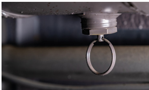
Detail odkalovacího ventilu. Zatažením ve směru šipky dojde k vypuštění usazeného kondenzátu.
