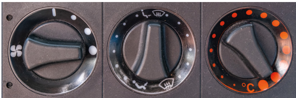
Nastavení ovladačů při přehřívání motoru v letních měsících není komfortní.
